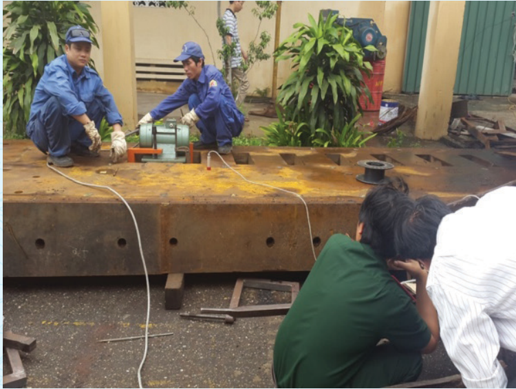
Hình 1: Lắp đặt đầu rung trên chi tiết thành trái của máy nghiền đá tại nhà máy Z125 - TCCNQP
